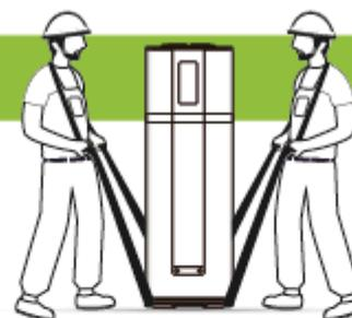
Les sangles de transport fournies avec l'appareil vous permettent de transporter et d'installer votre chauffe-eau en toute sécurité.
